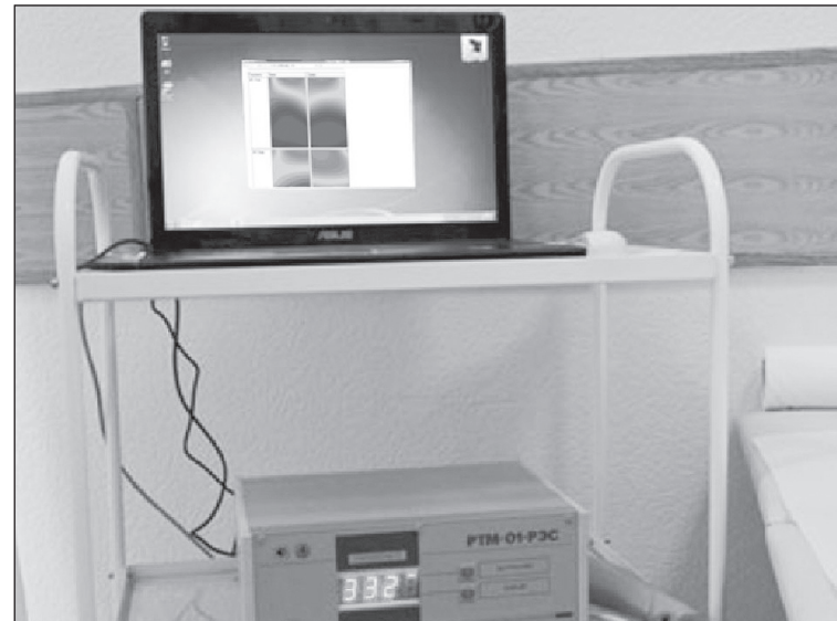
Так выглядит аппаратно-программный комплекс, позволяющий диагностировать флебологические заболевания (разработан под руководством А.Г. Лосева)
