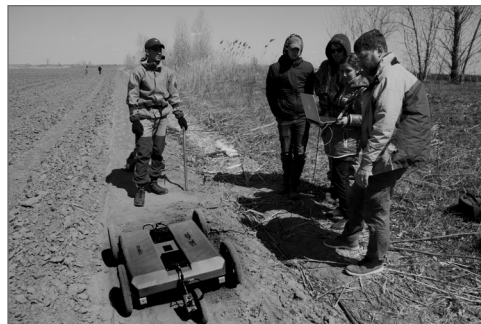
Определение глубины грунтовых вод с помощью георадара
