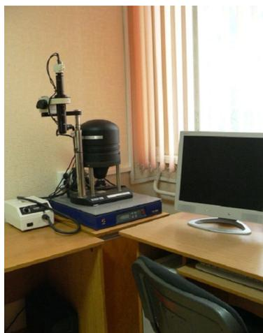
Рис. 2. Технологические комплексы для создания наномаркировок на базе микроскопов «NanoEducator» и «SolverPro»
