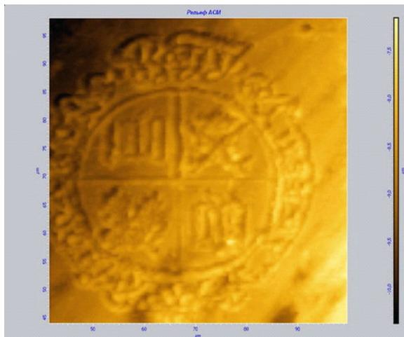
Рис. 3. Пример наномаркировки, нанесенной на поверхность образца из поливинилхлорида
